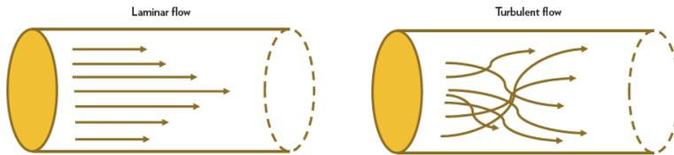
通過確保管道的內徑足以適應流體流速而不產生過多的湍流來實現層流。例如，水以每分鐘600加侖的速度流經內徑6英寸的線性管道1,000英尺所需的能量，幾乎是流經8英寸直徑管道所需能量的4倍，是流經10英寸直徑管道所需能量的12倍以上。還建議盡量減少管道中的急轉彎，尤其是大於90度的轉彎，因為它們也會產生消耗能量的湍流<sup>14</sup>。
