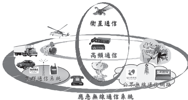
圖六：應急無線通信系統組成架構示意圖
